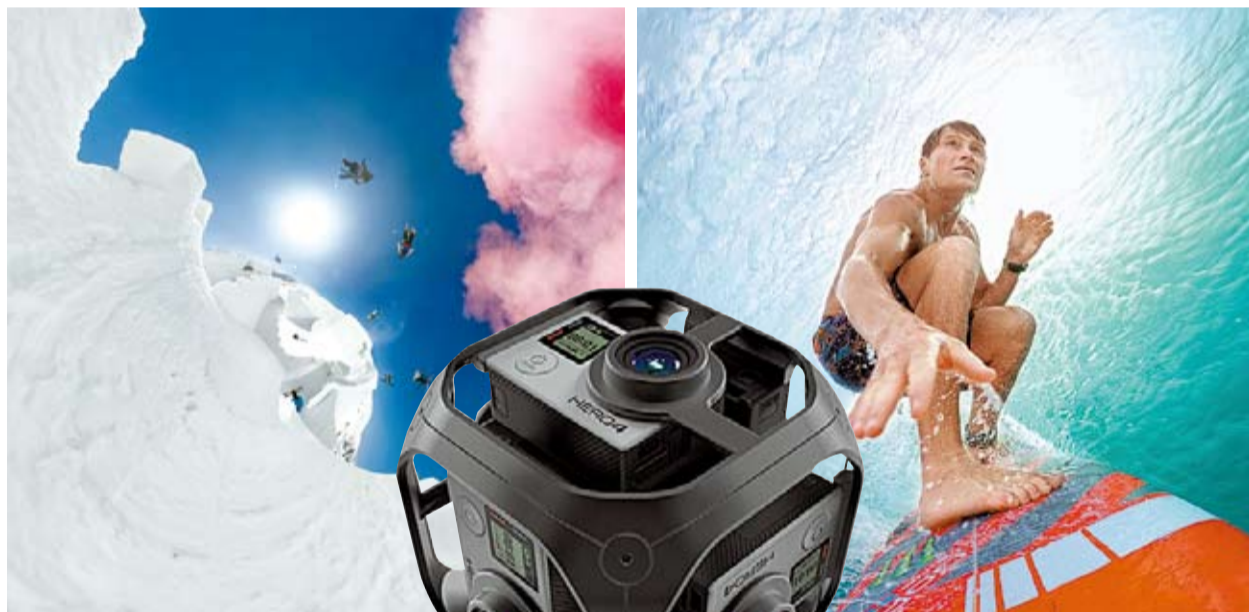
360도 VR 영상장비 옴니(Omni)로 촬영한 사진들. 옴니는 알루미늄 틀에 카메라를 양 방향으로 장착한 제품으로, 카메라 여섯 대가 다양한 각도에서 장면을 찍는다. 저장된 사진은 자동 정렬돼 스티칭(이러버)이 된다.
